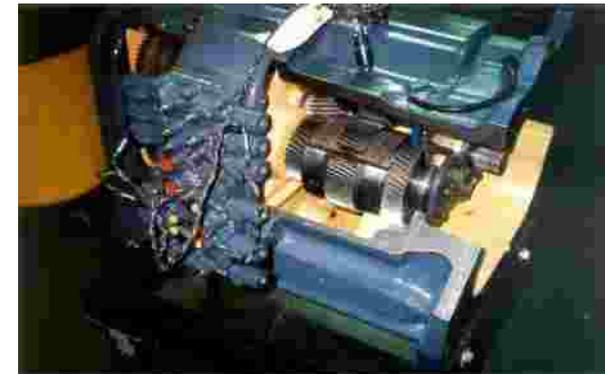
**Коробка передач Power Shift ZF, силовая, 18 вперед, 9 заднего хода. Привод на задние колеса, либо полноприводный вариант.**
