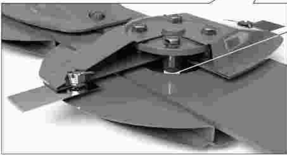
По этой канавке происходит разрушение шлицевого вала ступицы крепления тарелки.
