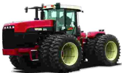
**Серия 2000** – серия включает две модели мощностью 335 л.с., 375 л.с., 400 л.с. Предназначены для тяжелых полевых работ с агрегатами с шириной захвата преимущественно до 12 м.
