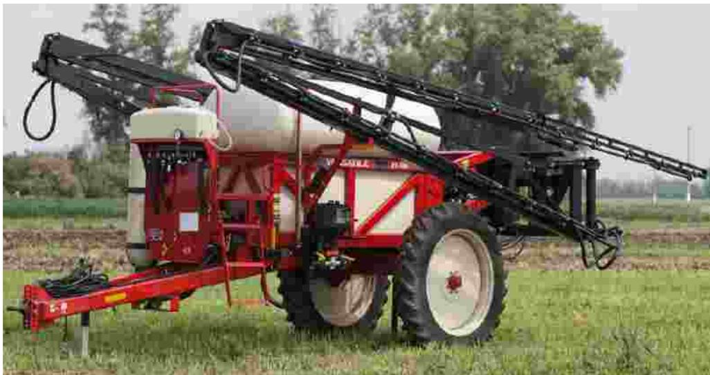
**Назначение** – проведение мероприятий по химзащите растений путем сплошной либо ленточной обработки. Внесение жидких удобрений.
