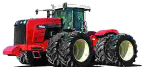
**Серия ННТ** – серия включает три модели мощностью 435 л.с., 485 л.с., 535 л.с., 575 л.с. Предназначены для тяжелых полевых работ с широкозахватными агрегатами (от 12 м.)
