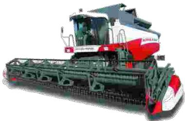
**ACROS 530/580/590+ Новинка** – высокопроизводительные комбайны 5+ класса с традиционной схемой обмолота, мощность 255/300/325 л.с.
