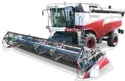
**TORUM 740/760** – высокопроизводительные роторные комбайны 7/8 класса, мощность 400/510 л.с.
